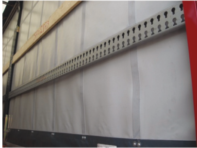
Figur 27: Aluminiumslægte med huller til blokeringsstænger
