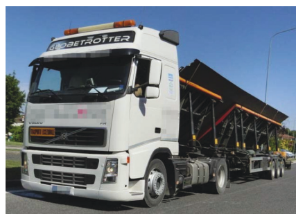
Figur 14: Stålplader transporteret under 45°
