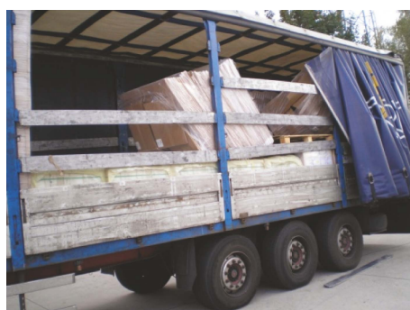
Figur 19: Utilstrækkelig fastgørelse af last udelukkende med strækfilm
