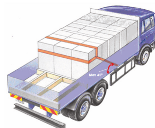
Figur 40: Fjederbelastet surring med sele
