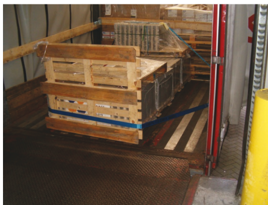
Figur 75: Anordning til fastgørelse bagud til blandet last
