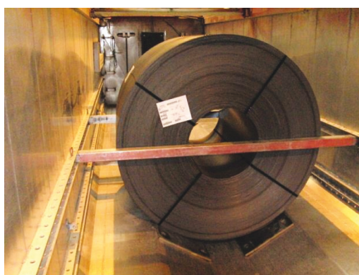
Figur 61: Transport af spole i specialkøretøj
