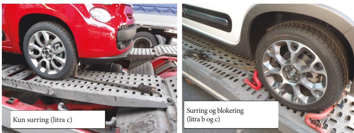
Figur 57: Fastgørelsesanordninger til biltransport
