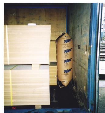
Figur 29: Luftpuder til blokering i siden
